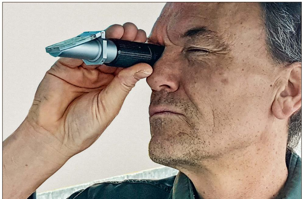
Mit einem optischen Refraktometer lässt sich der IgG-Gehalt der Milch leicht prüfen.
