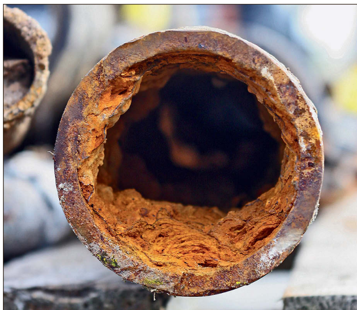
Wasser das durch rostige Leitungen fliesst enthält zu viel Eisen und hemmt die Aufnahme von anderen Spurenelementen.
